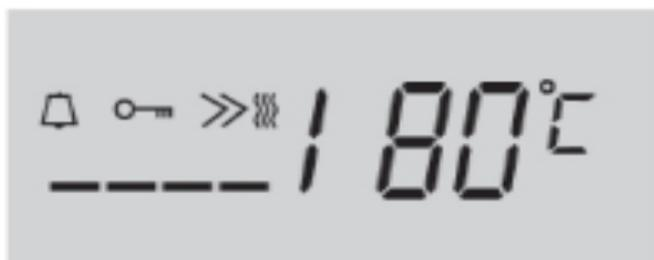
Духовой шкаф начинает нагрев после выбора программы приготовления, и на дисплей выводится температура камеры духовки. Возле пиктограммы температуры находится полоса-индикатор температуры, который отражает разницу между фактической температурой камеры духовки и заданной температурой.
